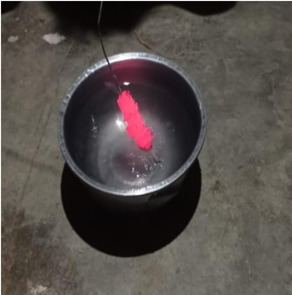
Gambar 3. Pendinginan Camshaft pada air garam
