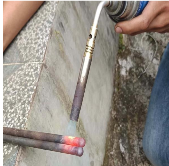
Gambar 4. Pemanasan sampel push rod
