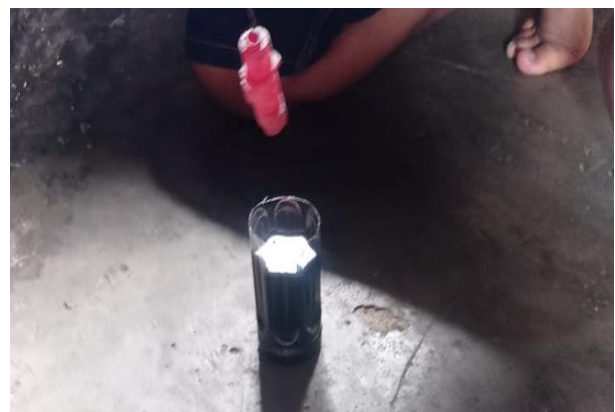
Gambar 2. Pendinginan Camshaft pada media oli
