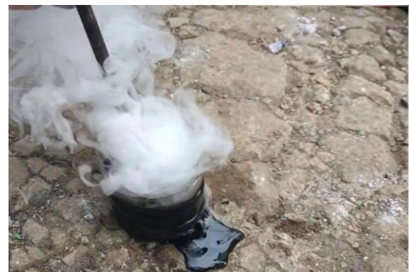
Gambar 5. Pendinginan sampel push rod oli
