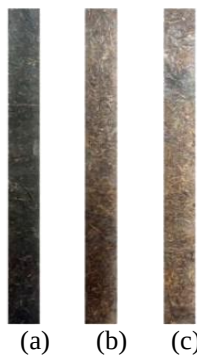
Gambar 5. Tampilan makroskopis lempeng komposit: (a) 5 wt%; (b) 10 wt%; (c) 15 wt%
