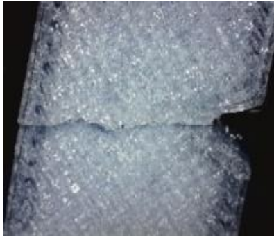
Gambar 16. Permukaan Patahan Makro Filamen rPET dengan Pola
