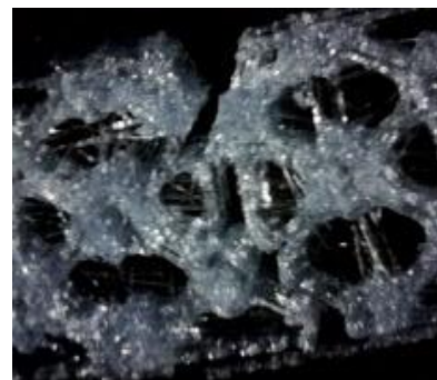
Gambar 15. Permukaan Patahan Makro Filamen rPET Pola Honeycomb 3
