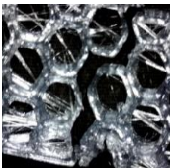
Gambar 13. Permukaan Patahan Makro Filamen rPET Pola Honeycomb 1
