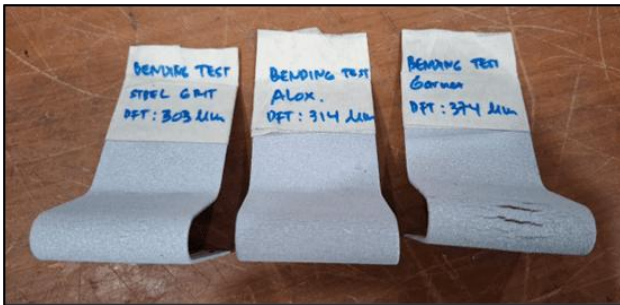
Gambar 3. Tampilan hasil pengujian tekuk
