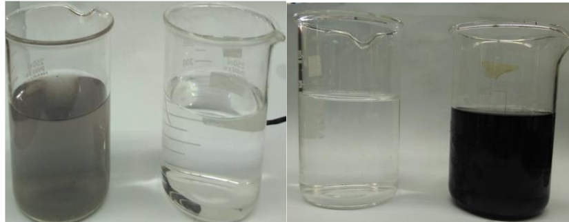
Gambar3: Hasil penelitian laboratorium dan uji aluminium untuk menjernihkan air limbah rumah tangga yang telah dilakukan oleh Pengabdi untuk diaplikasikan dalam kegiatan Pengabdian Masyarakat di Wilayah Keputih Surabaya.
