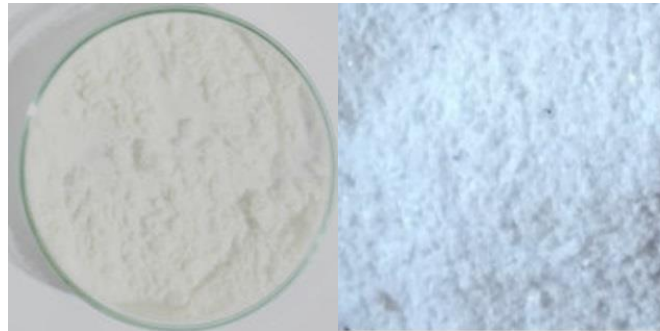
Gambar 2: Aluminium oksida yang telah berhasil diperoleh dari limbah kaleng bekas
