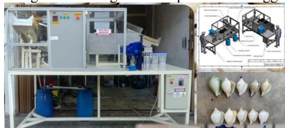
Gambar 5. Pembuatan Teknologi Mesin Pengelola Sampah Kulit Gonggong Dasar Kerajinan Tangan
