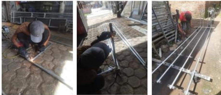
Gambar 4. Proses pembuatan tiang panel surya
