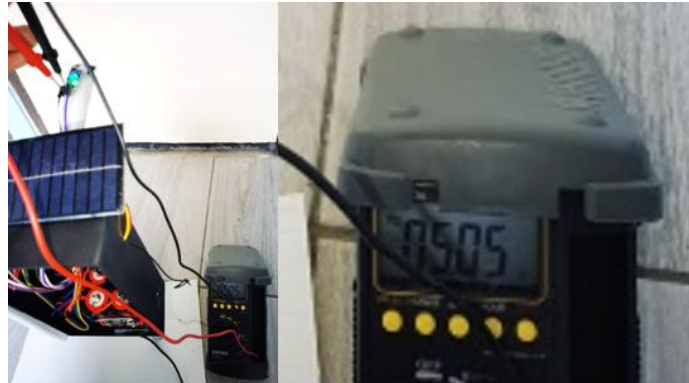
Gambar 15. Pengukuran sensor LDR saat lampu on (kiri) hasil pengukuran yang diperbesar (kanan)
