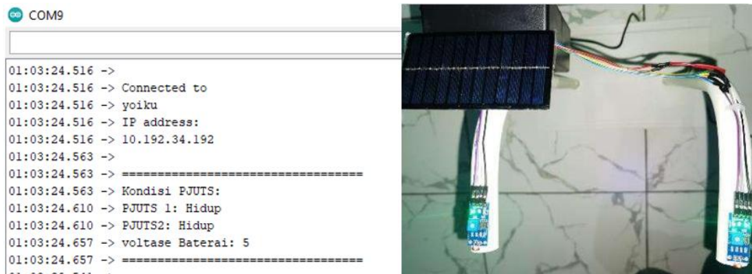
Gambar 14. Pembacaan sensor pada arduino IDE (kiri) dan kondisi lampu (kanan)
