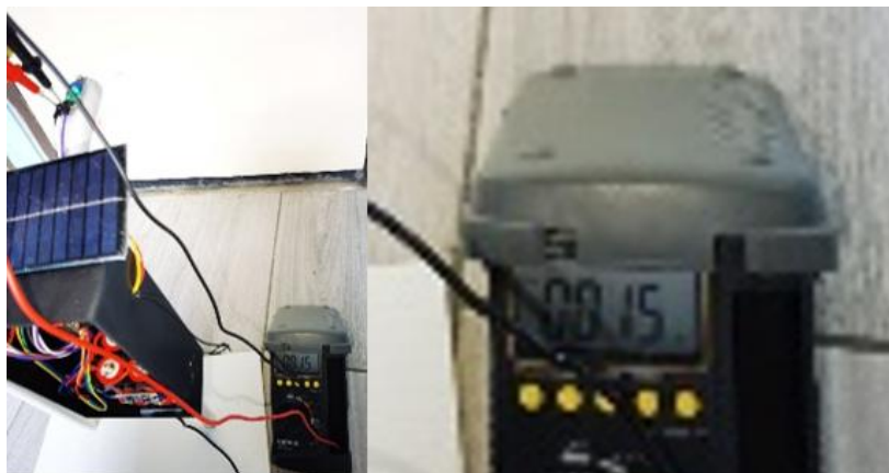
Gambar 13. Pengukuran sensor LDR saat lampu off (kiri) hasil pengukuran yang diperbesar (kanan)
