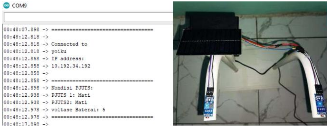
Gambar 12. Pembacaan sensor pada arduino IDE (kiri) dan kondisi lampu (kanan)
