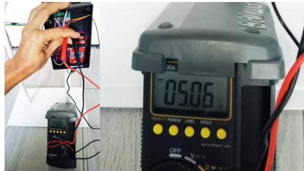
Gambar 17. Pengukuran voltase menggunakan multimer (kiri)hasil pengukuran yang diperbesar (kanan)
