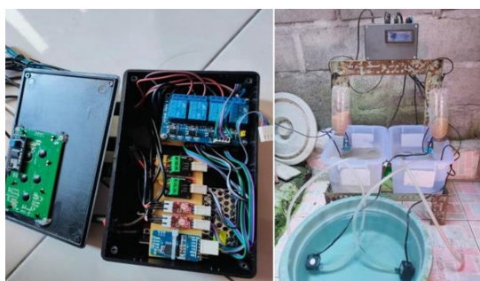
Gambar 5. Prototipe sistem otomatis budidaya ikan gurami
