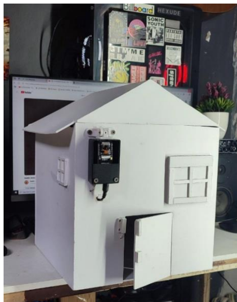
Gambar 10. Implementasi perangkat keras sistem pada maket residensial.
