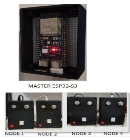
Gambar 5. Implementasi Perangkat WSN 4 Node
