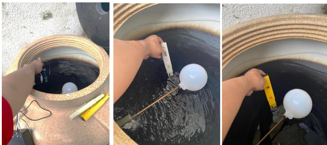
Gambar 5. Pemantauan (pH, TDS &amp; Kekeruhan) Tangki Air "Tandon"
