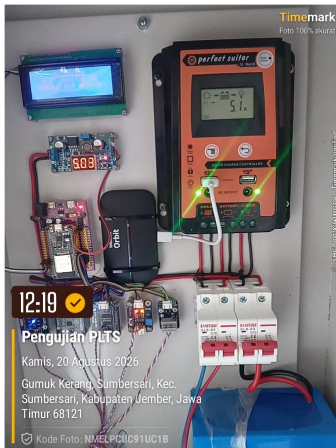
Gambar 2. Dokumentasi pengujian subsistem energi surya TirtaSmart
