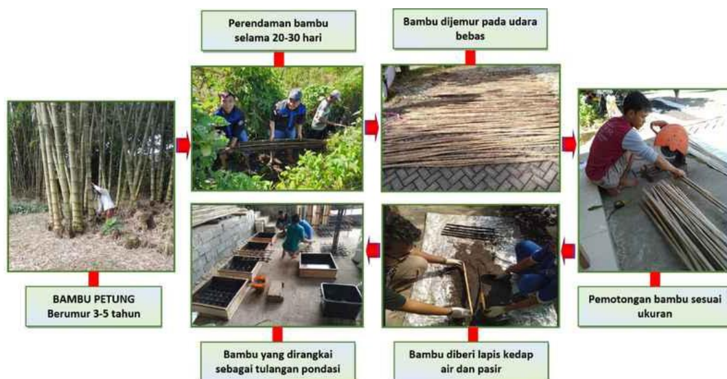
Gambar 2. Langkah-langkah tretmen tulangan bambu
