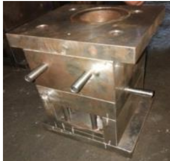
Gambar 3. Cetakan injection moulding
