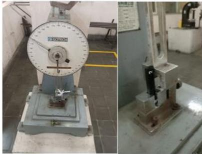
Gambar 7. Uji impak izod Merek GOTECH
