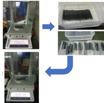
Gambar 10. Tahapan percobaan penyerapan air (Water Absorption)
