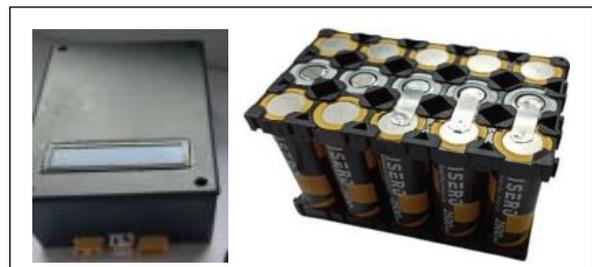
**Gambar 5.** Alat *Monitoring* dan Baterai rakitan
