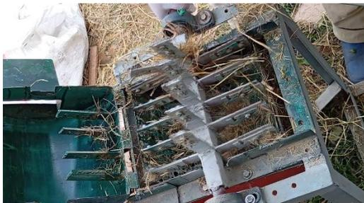
Gambar 22. Hasil Cacahan Tersangkut Pada Mesin A
