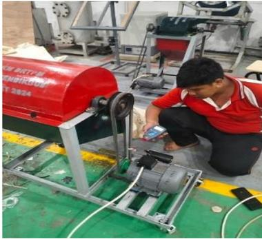
**Gambar 2.** Analisa Penurunan RPM Pada Mesin B Menggunakan Tool Tachometer
