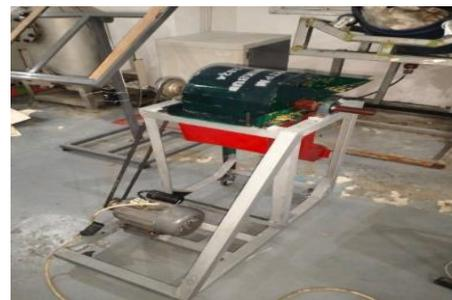
**Gambar 4.** Mesin Pencacah [7]
