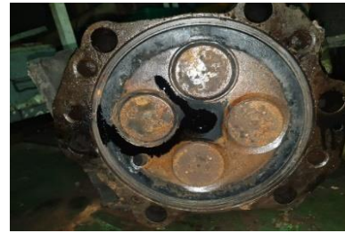
Gambar 1. Area valve berkarat karena bocor pada pendingin
