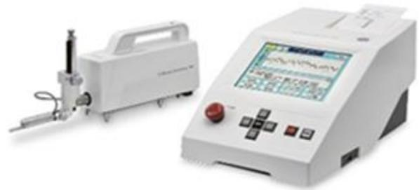
**Gambar 5.** Penguji kekasaran permukaan *profilometer Surfscorder SE500*
