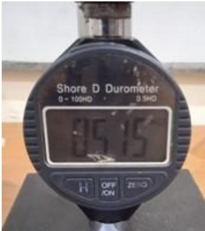
**Gambar 8.** Penguji Kekerasan Durometer Shore D
