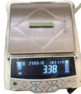
**Gambar 10.** Alat Uji Densitas
