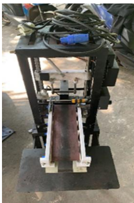
Gambar 1. Alat pemotong briket otomatis berbasis Arduino [9], [10]
