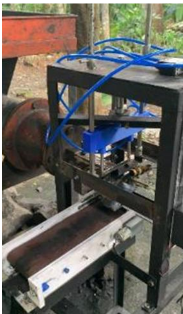
Gambar 2. Alat Pemotong Briket Otomatis Berbasis Pneumatika.
