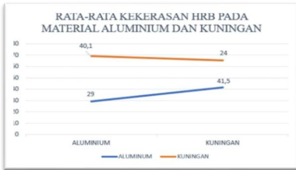
Gambar 3. Grafik Rata-Rata Kekerasan HRB Pada Material Aluminium Dan Kuningan.
