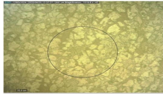
Gambar 2. Pengujian Struktur Mikro Pada Material Kuningan
