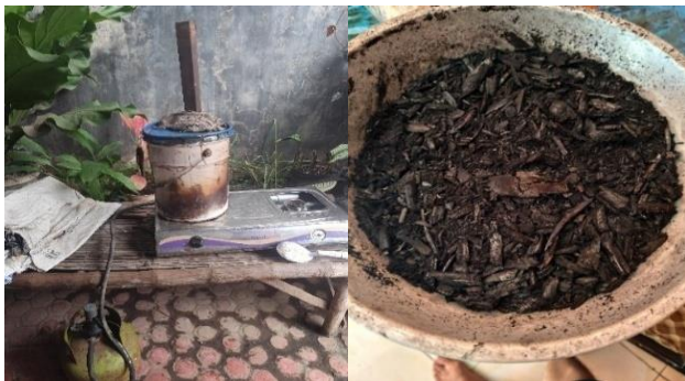
Gambar 2. Proses pengarangan dan hasil arang
