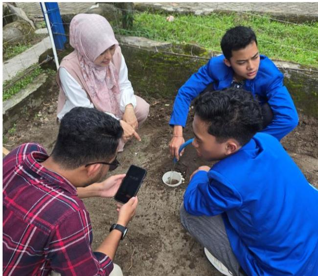
Gambar 2. Pengujian daya resap air pada biopori
