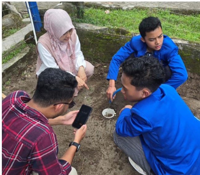
Gambar 2. Pengujian daya resap air pada biopori
